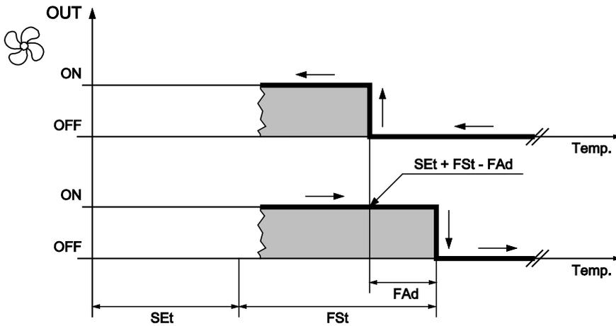
Диаграмма управления вентилятором по относительным порогам  $Fot > 0$  и  $FSt > 0$
